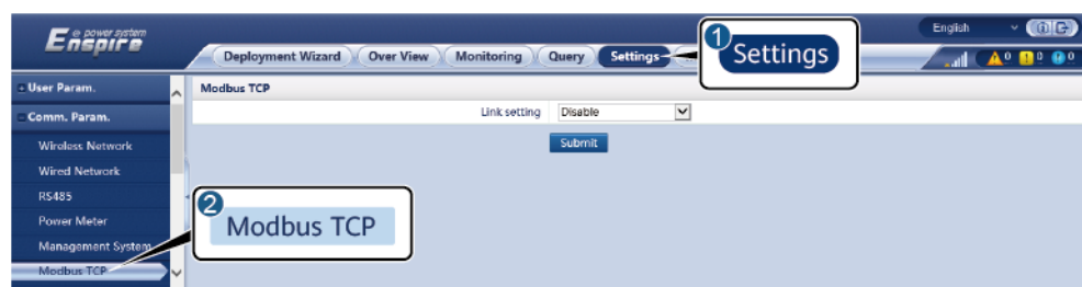
Figure 6-34 Setting Modbus TCP parameters
